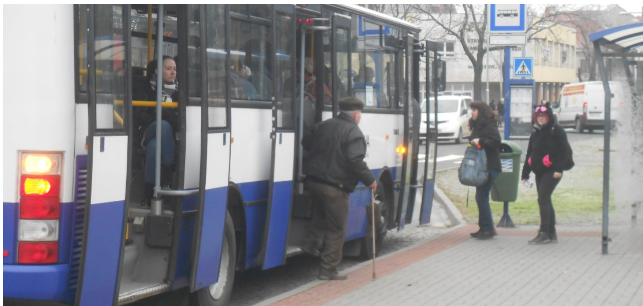
Obrázek 7.4: Příklad nedostatečně rekonstruované zastávky Přerov Prior – chybí nájezdová obruba, nástupiště je nízko
