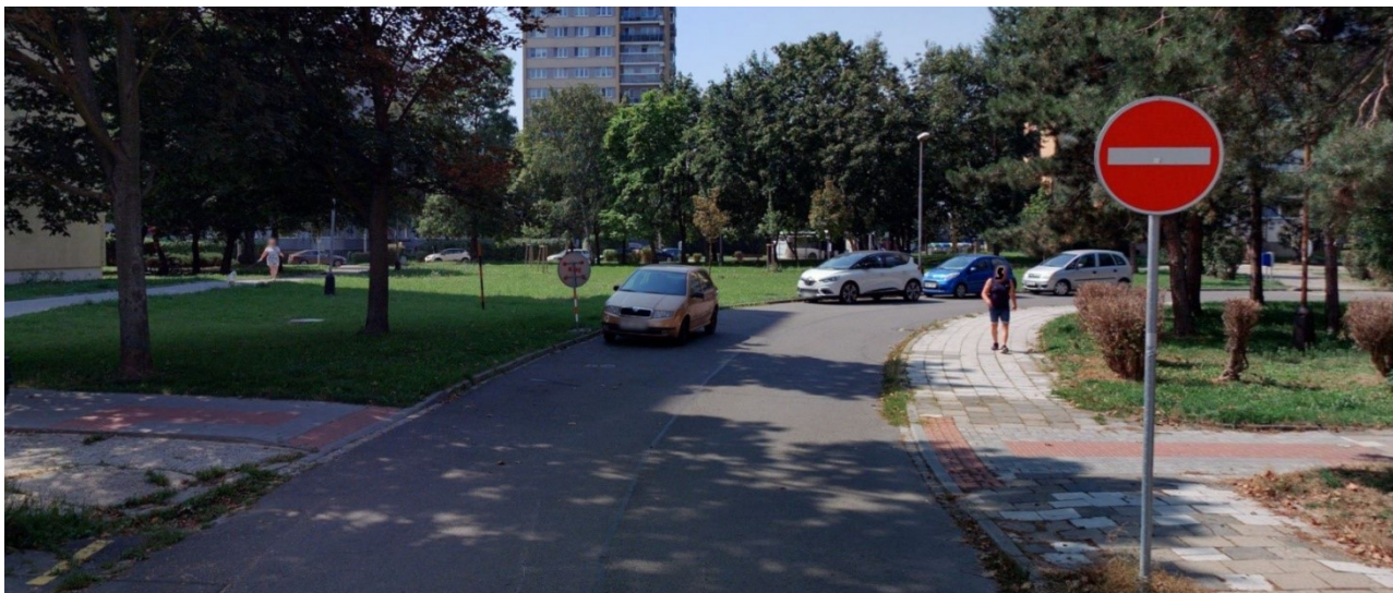
Obrázek 9.4: Rekonstrukce místa pro přecházení Sokolská, snížená obruba, doplněné signální i varovné pásy
