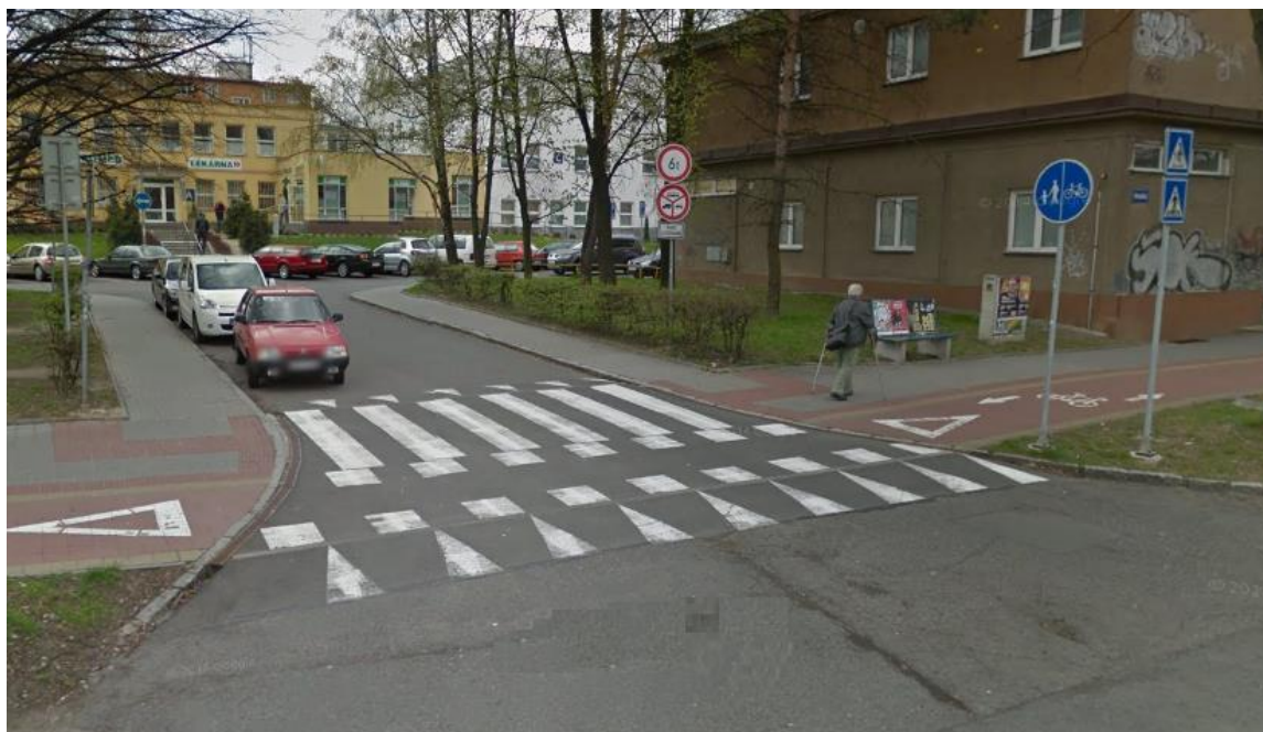
Obrázek 9.20: Příklad nevhodné ochrany chodců v rezidenční oblasti Jasínkova; Přerov; VDZ není vhodný bezpečnostní prvek při ochraně dětí, zvláště pokud je pod zastaveným vozidlem; místo označeno dětmi ZŠ Svisle k doplnění přechodu pro chodce
