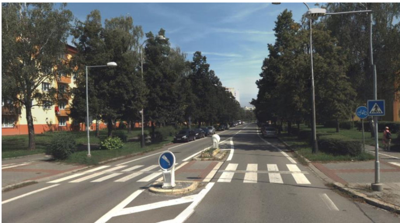
Obrázek 9.18: Provedení přechodu bří Hovůrkových x Kouřilkova, přechod se středním dělením se speciálním nasvětlením
